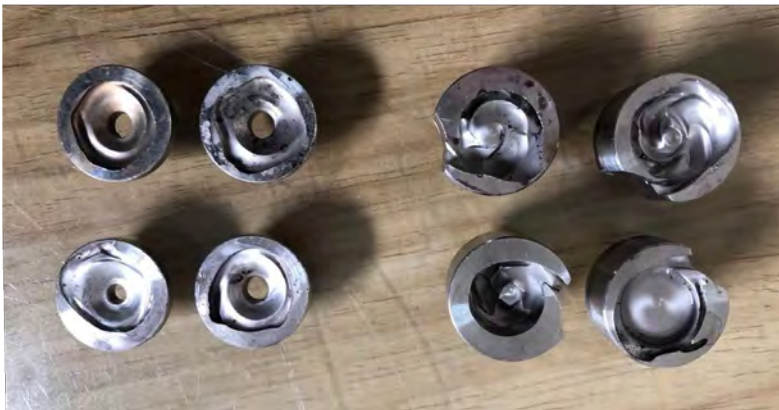
Onjuiste materiaalkeuze van de orifice disc en wervelkamer, wat resulteert in voortijdige slijtage. Neem voor advies over materiaal en compatibiliteit contact op met Delavan®.
