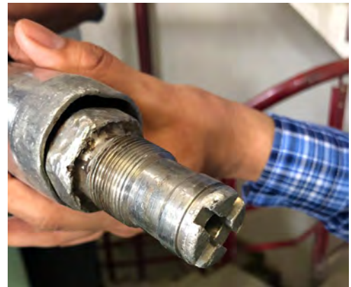
Schade aan schroefdraad op SDX® III nozzle.
